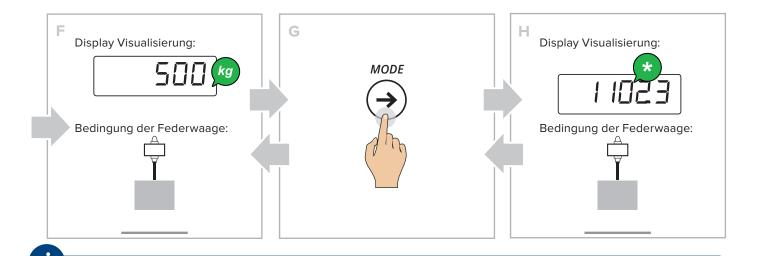
$\text{Durch Dr\"{u}cken von} \bigoplus^{^{\text{\tiny{MODE}}}} \text{kann die Maßeinheit jederzeit mit einem freien Umrechnungsfaktor umgerechnet werden.}$
