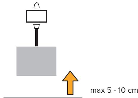
Die Wägegenauigkeit wird erreicht, wenn die Federwaage vollständig stillsteht.
