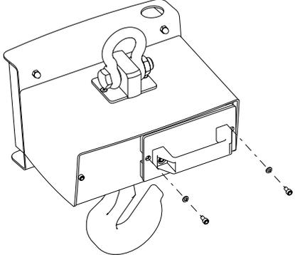
Das Diagramm zeigt die Rückseite einer Federwaage. Eine Hand ist dabei, die Schrauben an der Unterseite des Gehäuses zu lösen. Die Schrauben sind als gestrichelte Linien mit Kreisen dargestellt.                                         |
