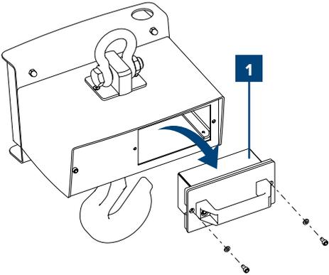
Das Diagramm zeigt die Federwaage mit dem Batteriepaket (1) herausgezogen. Ein blauer Pfeil zeigt die Bewegungsrichtung an. Ein blauer Kasten mit der Zahl '1' weist auf das Batteriepaket hin.                                           |
